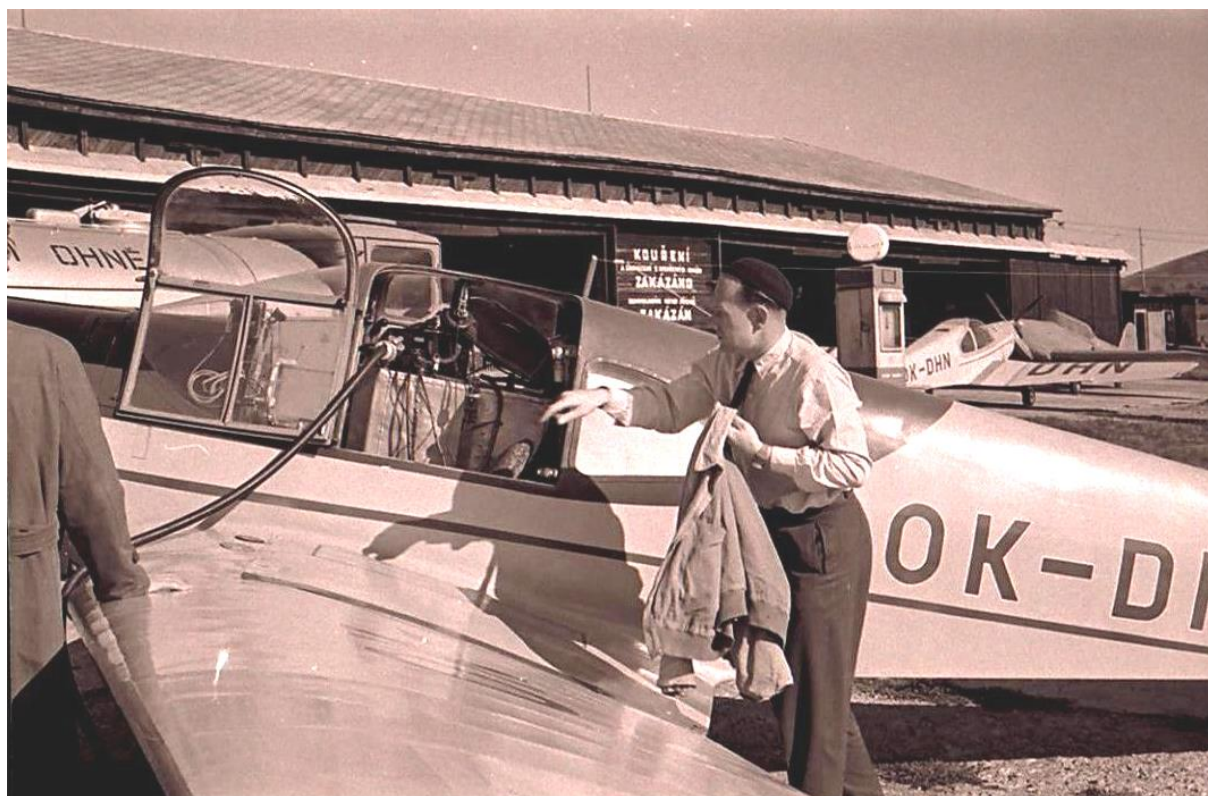
Obr. 2.4: František Novák plní palivo do přídatných nádrží letounu OK-DHH na letišti v Medlánkách
