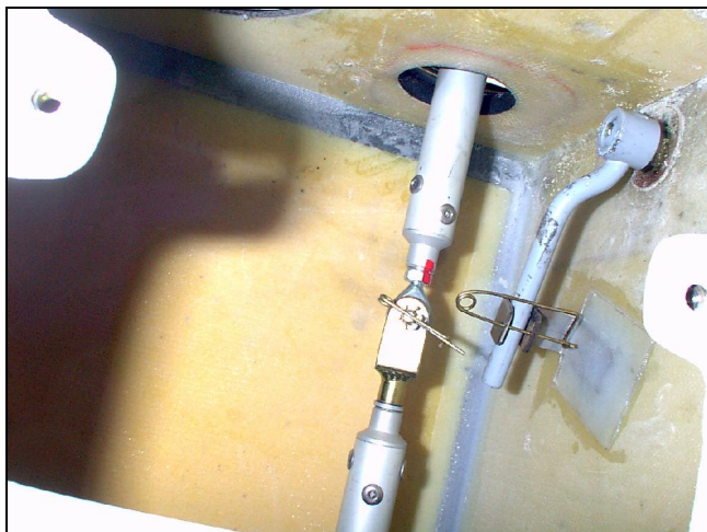
Vn ější hlavní spojovací ěp k ídla a spoj táhla k idýlek pravého k ídla
